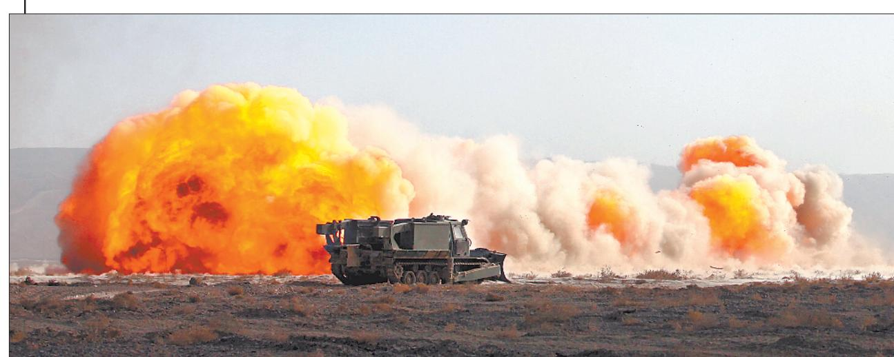
△1月4日，陆军第76集团军某旅工兵分队在祁连山深处开展机械爆破扫雷车破障训练。
