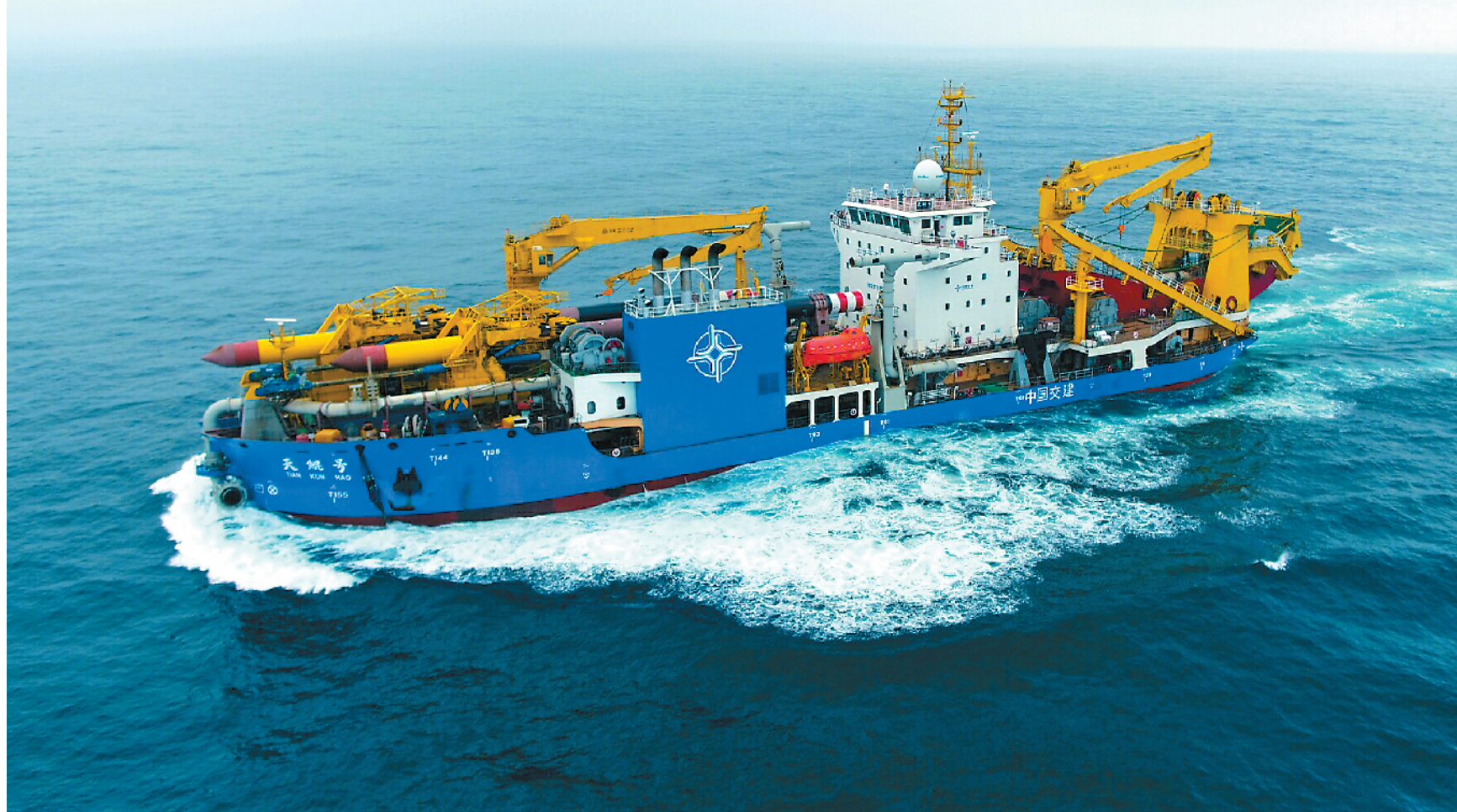
经过为期近4天的海上航行，首艘由我国自主设计建造的亚洲最大自航绞吸挖泥船——“天鲲号”成功完成首次试航。这标志着“天鲲号”向着成为一艘真正的疏浚利器迈出了关键一步。“天鲲号”全长140米，宽27.8米，最大挖深35米，总装机功率25843千瓦，设计每小时挖泥6000立方米，绞刀额定功率6600千瓦。图为“天鲲号”在海上航行试航中(6月12日摄)。
