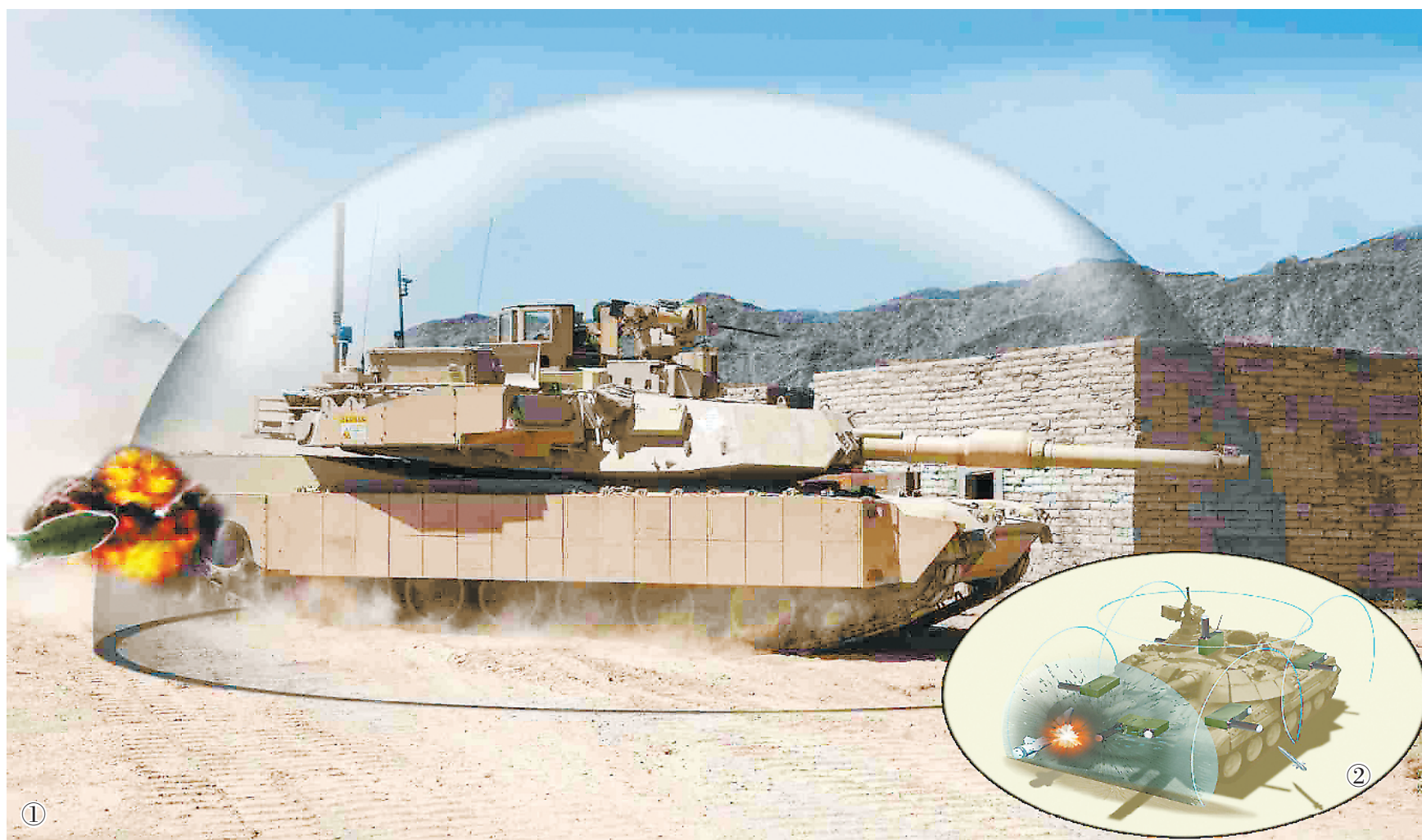
图①：安装在M1A2“艾布拉姆斯”坦克上的“战利品”主动防护系统工作示意图。图②：主动防护系统在最后一刻摧毁来袭威胁的示意图。
