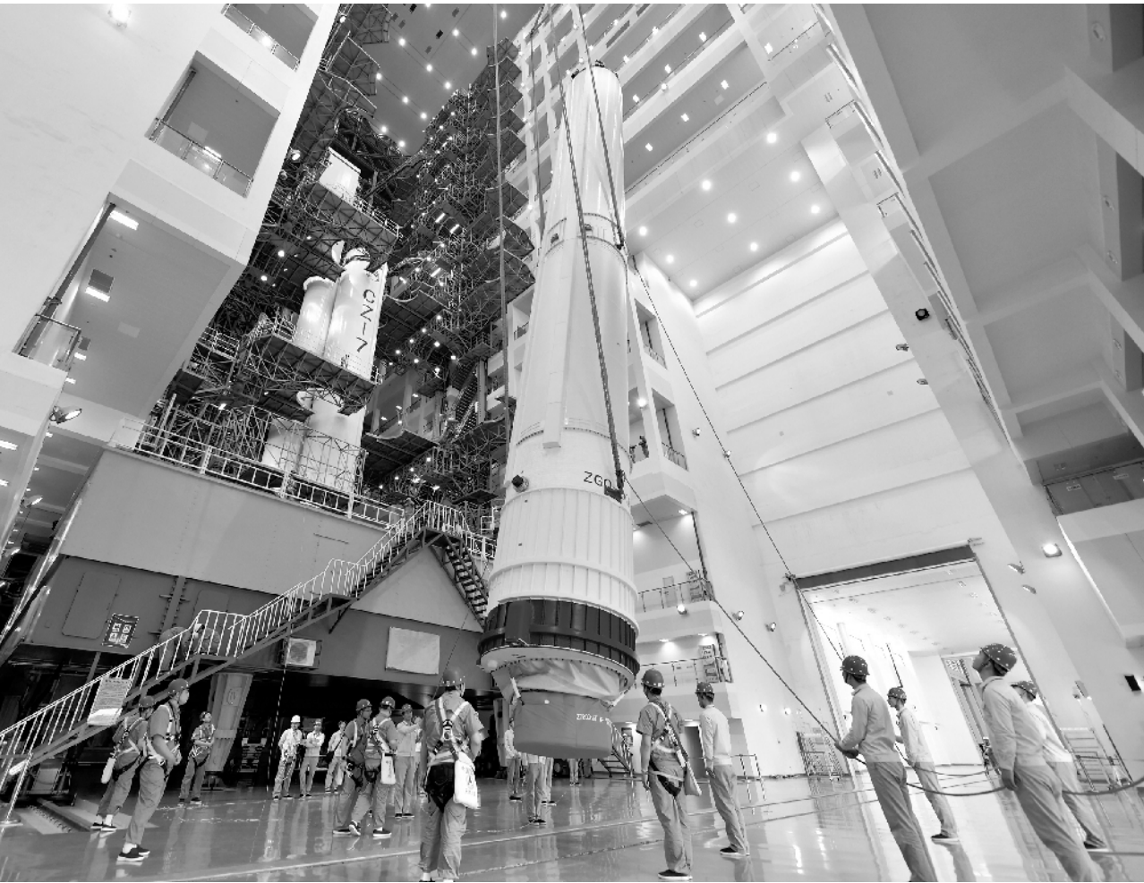
文昌航天发射场从从严实进行环境模拟，完善风险防控预案，确保发射任务万无一失，先后圆满完成“长征七号”“长征五号”首飞及“天舟一号”货运飞船发射任务。图为科技人员正在组织箭体垂直吊装工作。
