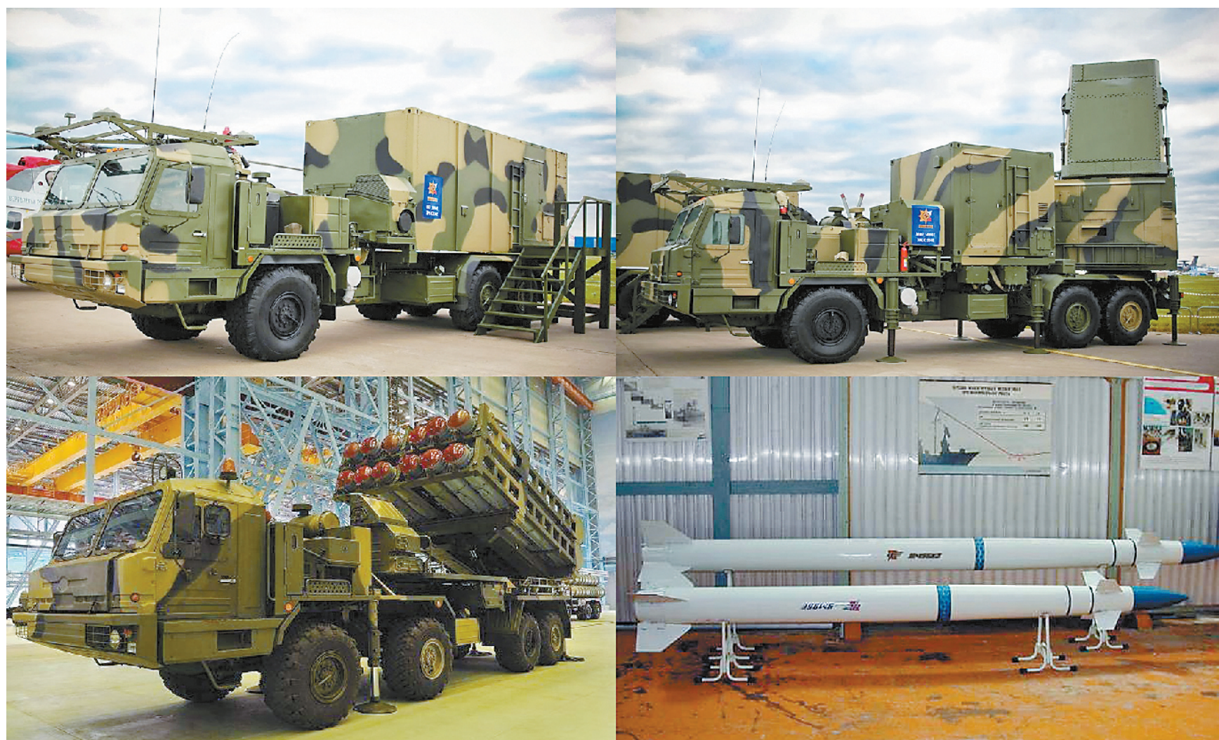
左上:50K6A指挥车;右上:50N6A多功能雷达车;左下:50P6A导弹发射车;右下:9M96系列导弹
