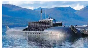
为搭载核动力无人水下航行器“波塞冬”,俄罗斯前不久专门对奥斯卡 II 级核潜艇“别尔哥罗德”号作了改进。改进后,其长约184米、宽约18米,可容纳6枚“波塞冬”,堪称潜艇中的巨无霸。
