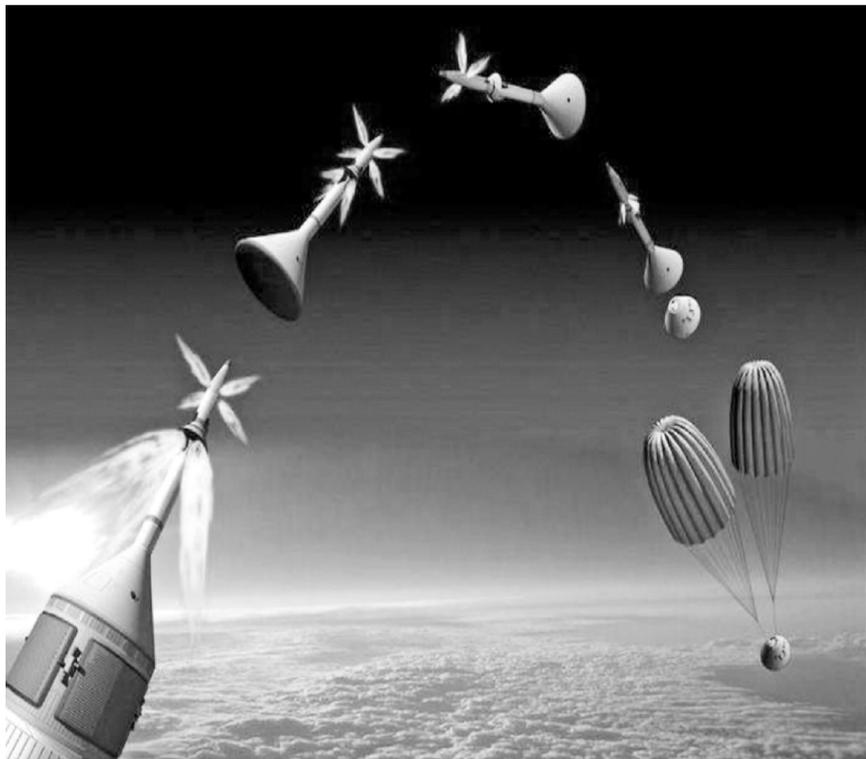
最快的速度将载人飞船带离火箭并启动自带发动机，将飞船带到远离发射台的安全地带降落，从而挽救航天员的生命。因此，逃逸塔也被称作航天员的“生命之塔”。
