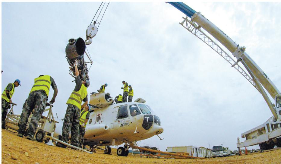
日前,中国第二批赴苏丹达尔富尔维和直升机分队官兵克服各种困难,为一架代号为“UNO-795”的直升机同时更换了到寿的主减速器和左发动机。目前直升机性能参数稳定,工作状态良好。这一成功实践,为维和直升机分队在海外进行装备保障探索了新路,积累了经验。
