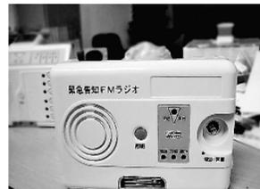
日本是地震多发国家，也是全球首个研发出地震预警系统的国家。紧急地震速报系统的检测方法有两种：一种是利用地震观测网中离地震中心最近的几个监测台，快速确定地震的时间、地点和震级，然后通过现代通信方式，为人们争取时间采取应对措施。另一种是单点地震预警，即利用地震纵波和横波的传播特点进行预警，当某一点的地震仪检测到很强的纵波时，立即发出预警信号。日本紧急地震速报系统将两种检测方式结合起来，有效减少了检测盲区，增大了预警范围。
