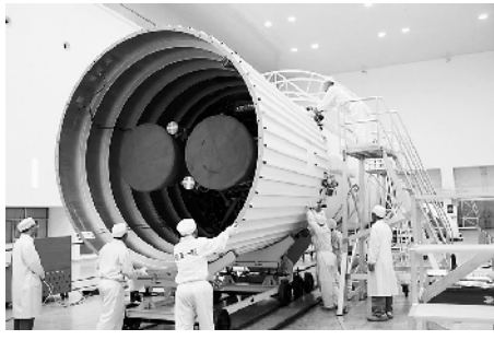
长征三号甲系列运载火箭在国家重大工程建设中发挥了关键作用，耀眼成绩背后，有一支优秀的运载火箭研发团队。这是在西昌卫星发射中心总装车间，科研人员正在对尾裙。
