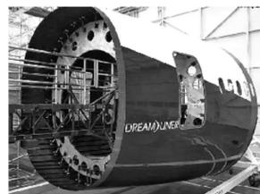
在航空航天制造领域,应用碳纤维复合材料极其重要。因为飞行器在飞行过程中运动速度高、过载大,选材制造时对材料强度和重量要求异常严格。而碳纤维复合材料作为现有结构强度高、相对质量轻的特殊材料,其强度是钢的5倍、铝的3倍,而比重只占铝的1/2、钢的1/5,能够很好满足飞行器选材要求。
