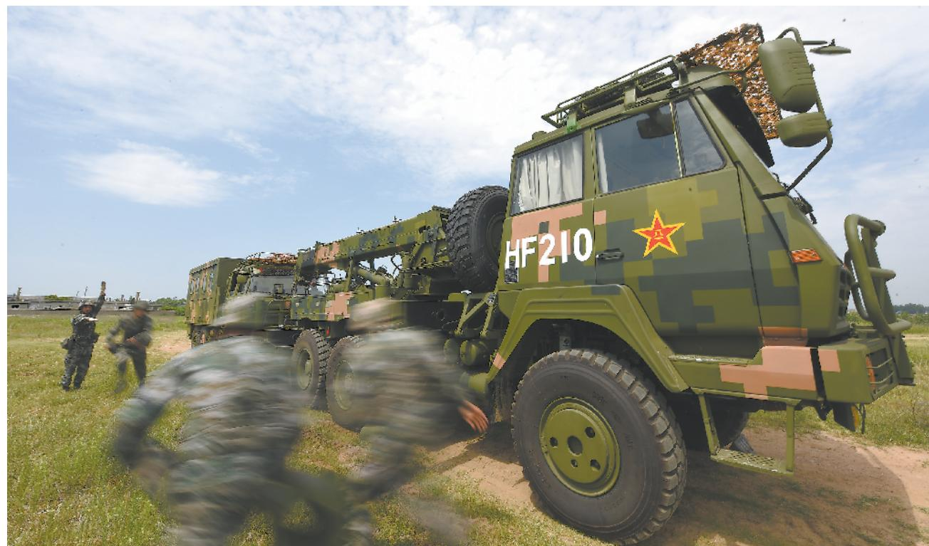
随车悬臂吊装、液压绞盘牵引、底部推铲清障……6月中旬,第73集团军某旅野战修理所内,一辆新型轮式装备抢修车正在展开作业。
