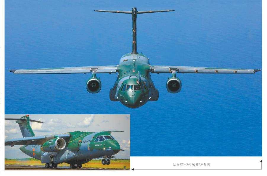
比颇高。该机配备两台涡扇发动机,最大巡航速度870公里/小时,实用升限超过10000米,满载情况下航程约2800千米,空载航程超过6000千米。
