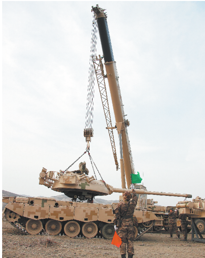
11月9日，新疆军区某团组织装甲装野战抢修演练，锤炼官兵战地抢修技能。图为快速吊装更换坦克炮塔。本报特约通讯员 袁凯摄
