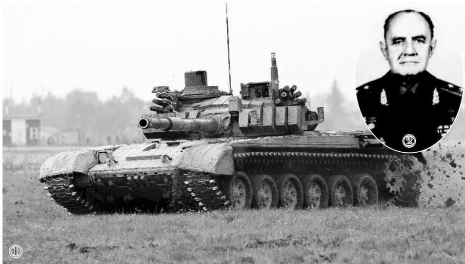
T-64坦克相比，它拥有同样的火力和防护性能，但换用更省油的柴油机，燃料消耗只有T-64的四分之一，最大行程却增加了一半以上。
