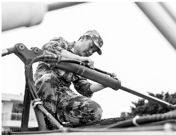
图为刘文军在检查两栖突击车液压油管。 徐明章摄
