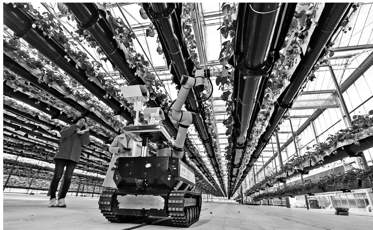
素有“中国草莓之乡”美誉的浙江省建德市杨村桥镇,积极推进“草莓小镇”智慧农业建设,打造“草莓种植产业数字化平台”。图为新研发的草莓采摘机器人伸出机械臂,根据程序设置自动采摘成熟的草莓。新华社记者 徐显耀
