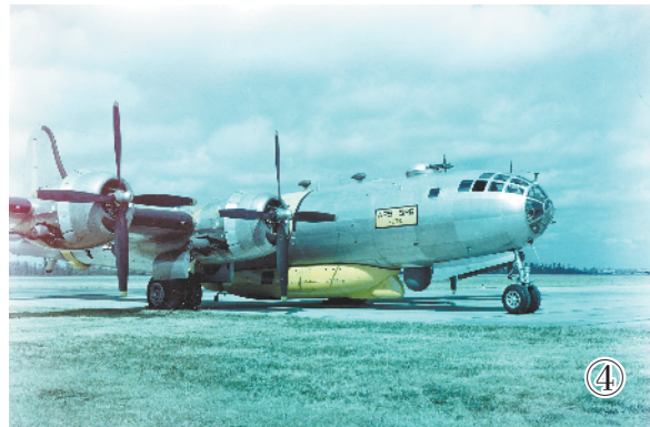
图1:俄罗斯安-12PS搜救机。图2:英制空投式救生套件ARK。图3:英制空投式救生套件ARK构成部件图。图4:可空投A-3救生艇的SB-29“超级小飞象”搜救机。图5:美制通用空投救生套件UNI-PAC。图6:配备有UNI-PAC救生套件的P-8飞机。
