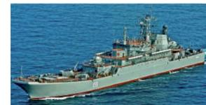
在两栖舰艇中,坦克登陆舰属于“老资格”。它最大的特点是能直接抵滩登陆,打开舰艏门,两栖车辆就可以直接上岸。坦克登陆舰有大型和中型之分。大型登陆舰满载排水量可达万吨以上,用于远洋跨海作战。中型登陆舰可搭载的作战车辆相对较少,用于遂行一般的抢滩登陆作战任务,在续航能力上与两栖运输舰有较大差距。
