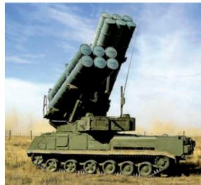
带式装甲底盘,这种通用底盘可承受更大载荷,最大公路速度可达70千米/小时。而且,该底盘可以通过改变液力变速器的使用状态来适应不同路况。通俗地讲,当车辆在路况较差的道路上行驶时,液力变速器发挥保护作用,可通过自适应路面来减震;当车辆在路况较好的道路上行驶时,车辆则调整为高速行进模式。对于在行驶过程中产生的大量高热废气,该底盘可直接将其引射入系统外,省掉风扇及其传动装置,简化冷却步骤,降低功率消耗。这也使该底盘能在高温下长时间行驶,具有良好环境适应性。
