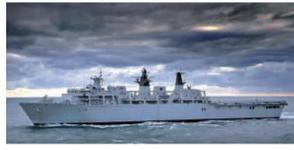
现代船坞登陆舰除强调运力外,还较注重自身防护能力,如装备有舰炮、近程防空导弹、机枪,等等。英国海神之子级两栖船坞登陆舰也不例外,其配备有“守门员”近程防御武器系统和厄利孔20毫米舰炮。当然,和其他大型两栖舰艇一样,该级舰也不擅长直接抢滩登陆。
