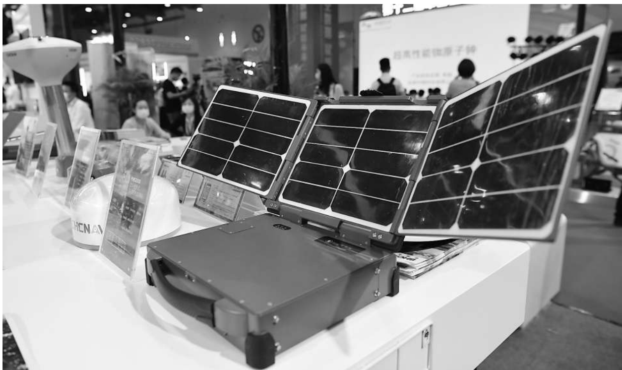
在江西南昌举行的第十二届中国卫星导航成就博览会上，一系列硬核科技产品纷纷亮相。图为展出的北斗便携式移动应急监测站，目前已应用到救灾工作中。新华社记者 彭昭之摄
