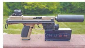
为进一步挖掘手枪战斗潜力,瑞士B&T公司拿出了别出心裁的方案——研发出一型名为“USW(通用勤务装备)”的增强型手枪套件。普通的手枪安装了该型套件,不仅外形似冲锋枪,战术性能也得到一定提升。
