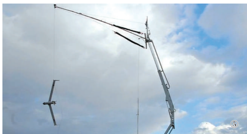
图①②:无人机垂直降落;图③④:无人机撞网回收;图⑤⑥:无人机“天钩”回收。
