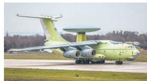
与上一代A-50预警机相比,俄罗斯A-100预警机的性能在很多方面有较大提升。它采用的伊尔-476运输机平台配备更大马力的发动机,这使得其航程和搭载能力显著提升。
