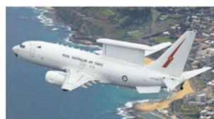
两组天线阵列垂直安装于技术相对成熟的中型飞机机身尾部,仿佛鱼的“背鳍”,另一组天线阵列水平安装在“背鳍”上部……澳大利亚空军的主力预警机——“楔尾”的雷达天线布局有点特殊。
