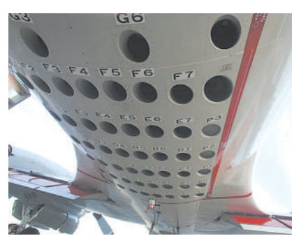
图为投放声呐浮标的蜂巢式发射管。新一代反潜巡逻机的声呐浮标投放器开始采用旋转发射模式。
