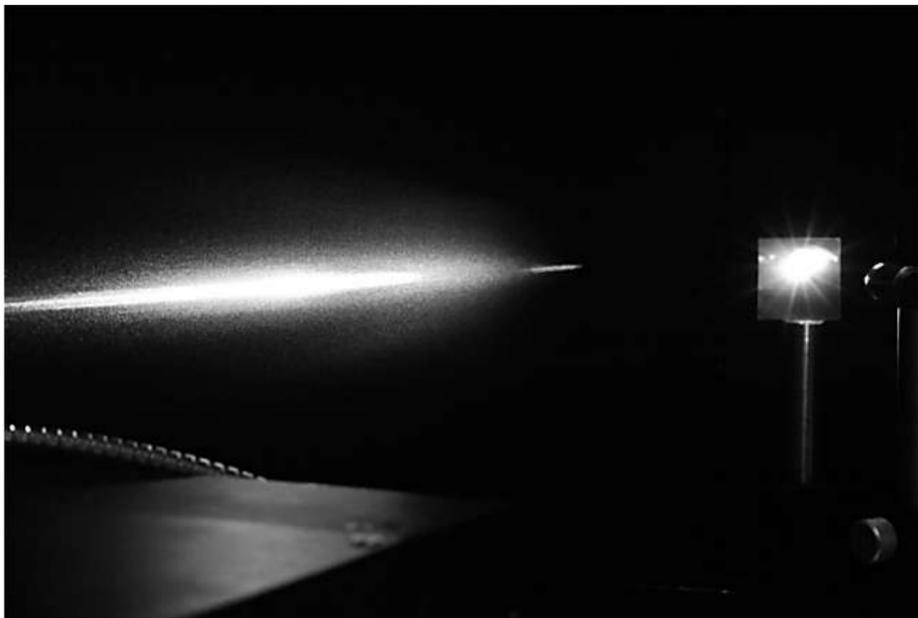
其是位于中红外波段(2500~5000纳米)的超连续谱激光光源,可覆盖常见红外热寻导引头的典型工作波段。这样,就可有效实现对敌方精确制导武器的干扰及致盲。目前有报道称,美军已将包含中红外超连续谱激光光源的定向红外对抗系统,装配在大型飞机和直升机底部,并配备旋转臂以扫描飞机周围可疑目标,实现对红外制导导弹导引头的干扰,最终使其偏离固定轨迹、脱离目标。
