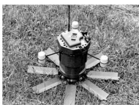
地雷作为一种被动防御性武器,主要在战场上造成被动杀伤。随着探测技术、传感器技术和微处理器技术等高新技术的发展,能够自动探测、识别并攻击目标的寻的地雷,将在未来战场上展现威力。
