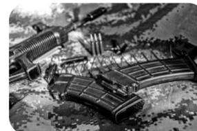
例如，步枪AR-15采用的是5.56毫米口径的瓶形弹，其锥度小，瓶口斜向下侧与直筒弹相似，设计师就将可以填充20发子弹的弹匣设计成方形。
