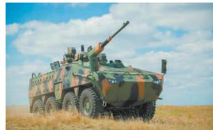
在步兵战车中,哈萨克斯坦的“雪豹”步兵战车属于一种特殊的存在。与传统步兵战车尽可能地“矮下身子”不同,它更像一个长着獠牙的大象,体形相对高大。该车采用发动机前置的布局,后部为大尺寸的载员舱,可搭载9人。
