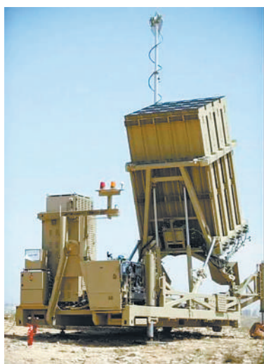
每个“铁穹”系统有3到6部20联装发射装置。
