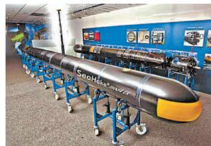
朝着目标加速航行的DM2A4重型鱼雷因为与鲈鱼的游动有几分相似,所以,出口型DM2A4重型鱼雷有了一个形象的名字:“海鲈”。作为一款导线反舰反潜鱼雷,“海鲈”采用纤细的光纤来传输信号,隐蔽性好,抗干扰能力强。结合惯性制导和声自导方式,它命中目标的精度较高。
