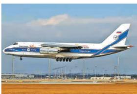
在现役军用运输机中,论载重量,安-124运输机可坐“头把交椅”。它全长近70米,翼展超过73米,最大载重量150吨。作为苏联安东诺夫设计局的作品,它旨在运送机
