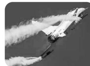
20多年后，第十二届中国国际航空航天博览会上，加装了矢量喷口的歼-10B推力矢量验证机飞出“眼镜蛇”“落叶飘”等超机动动作，标志着我国国产发动机技术取得重要突破并进入实用阶段。
