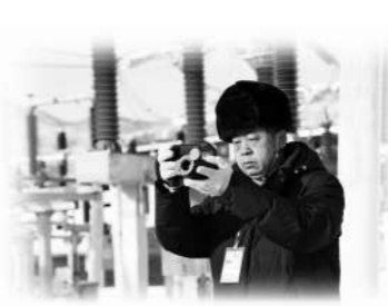
陈奇利用红外测温仪测量设备温度，判断设备工作状态。 侯玉春摄
