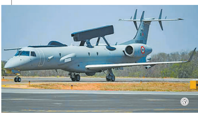
图①:A-50预警机;图②:卡-31预警直升机;图③:安-71预警机;图④:加装“瞭望台”空中预警系统的“墨林”预警直升机;图⑤:在巴西ERJ-145客机上加装印度国产雷达的“天空之眼”预警机;图⑥:E-7“楔尾”预警机。
