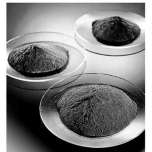
目前,坦克车辆大量使用的铅酸蓄电池因容量低、自放电率高而需要经常充电,且维护和搬运十分不便,制约了坦克作战性能的发挥。为此,美、日等国利用稀土贮氢合金材料制成了一种新的蓄电池。该电池具有能量密度高、耐过充、抗震、低温性能好、寿命长等特点,对未来主战坦克的发展可产生非常重要的加持作用。
