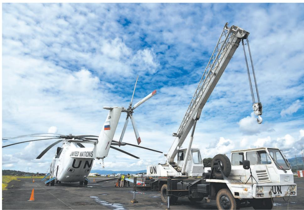
日前, 接联刚稳定特派团南战区命令, 我第25批赴刚果(金)维和工兵分队派出吊车作业组, 前往卡武穆机场帮助联合国人员完成MI-26型运输直升机尾翼吊装任务。分队专业高效的作业能力, 获得联合国工作人员赞誉。图为我维和官兵在进行吊装作业。
