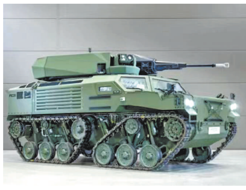
采取四套独立履带系统的“卢瓦”空降装甲车
