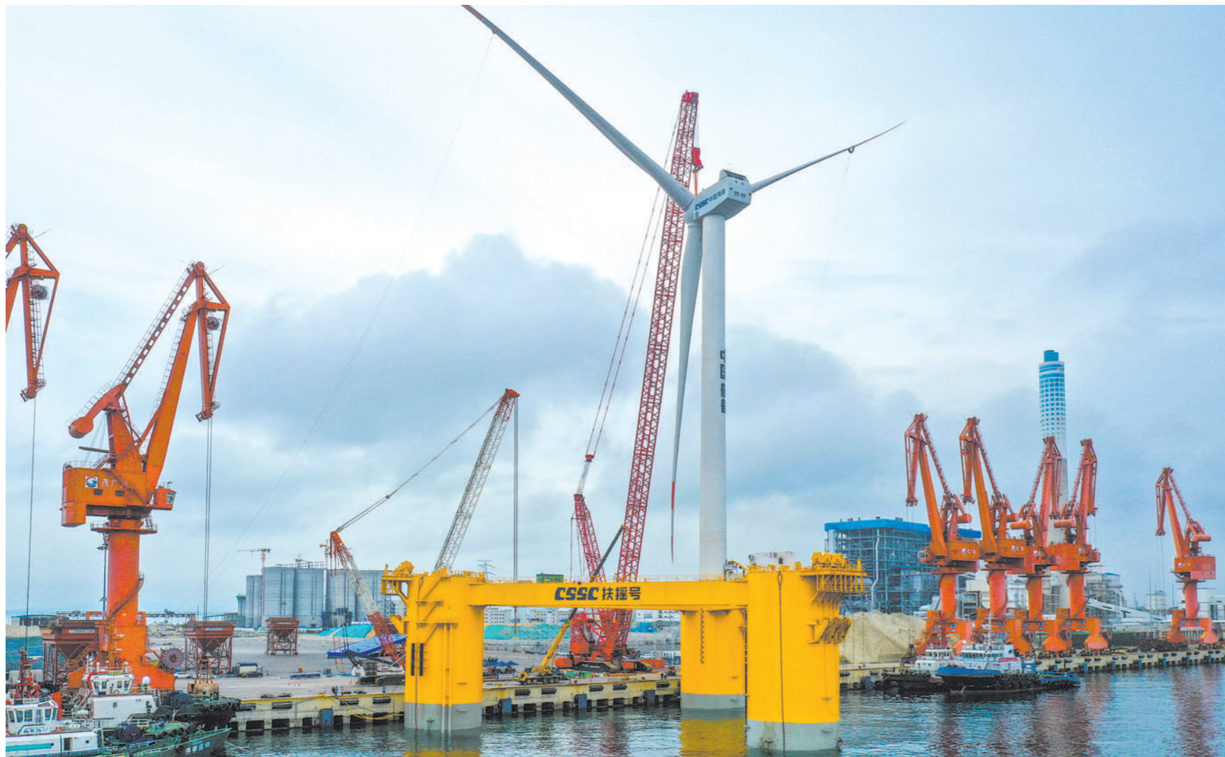
5月29日，完成总装的国内首台深远海浮式风电装备“扶摇号”在广东茂名广港码头静待拖航，将前往平均水深达65米的广东湛江罗斗沙海域进行示范应用。 新华社记者 刘大伟摄
