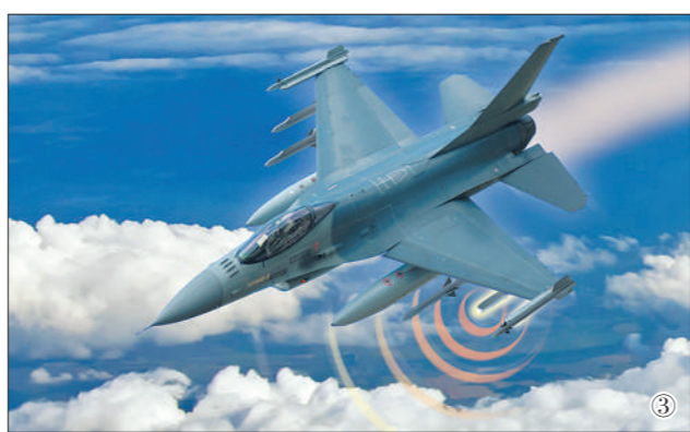
图①：法军TALIOS多功能瞄准吊舱；图②：俄军GUV-8700地对地攻击机炮吊舱；图③：以军ELL-822SB机载电子战自卫吊舱；图④：美军ALQ-99电子干扰吊舱。
