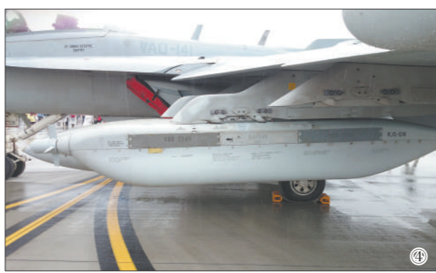
图①：法军TALIOS多功能瞄准吊舱；图②：俄军GUV-8700地对地攻击机炮吊舱；图③：以军ELL-822SB机载电子战自卫吊舱；图④：美军ALQ-99电子干扰吊舱。
