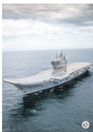
图②:海试的过程也是发现问题的过程,印度建造的维克兰特号航母在第二次海试时曾发现存在纵摇现象。
