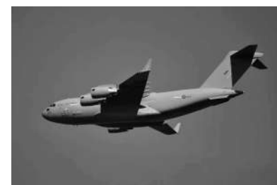
翼,可以削弱机翼气压差所引起的涡流强度,达到增压减阻效果,最多可降低4%的油耗,使战机拥有更远航程和更大载弹量。
