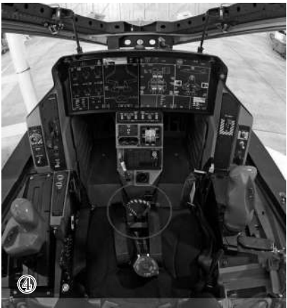
图①:英国马丁·贝克公司早期研制的量产型弹道式弹射座椅 Pre-Mk1; 图②:米格-29战斗机; 图③:F-35战机上使用的US-16E型弹射座椅; 图④:图内所标示的是弹射座椅的弹射拉柄(环); 图⑤:俄军战机装备的K36通用弹射座椅。
