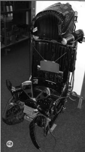
图①:英国马丁·贝克公司早期研制的量产型弹道式弹射座椅 Pre-Mk1; 图②:米格-29战斗机; 图③:F-35战机上使用的US-16E型弹射座椅; 图④:图内所标示的是弹射座椅的弹射拉柄(环); 图⑤:俄军战机装备的K36通用弹射座椅。
