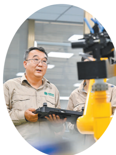
张黎明和同事在调试第四代配网带电作业机器人(2022年9月8日摄)。 新华社记者 赵子硕摄
