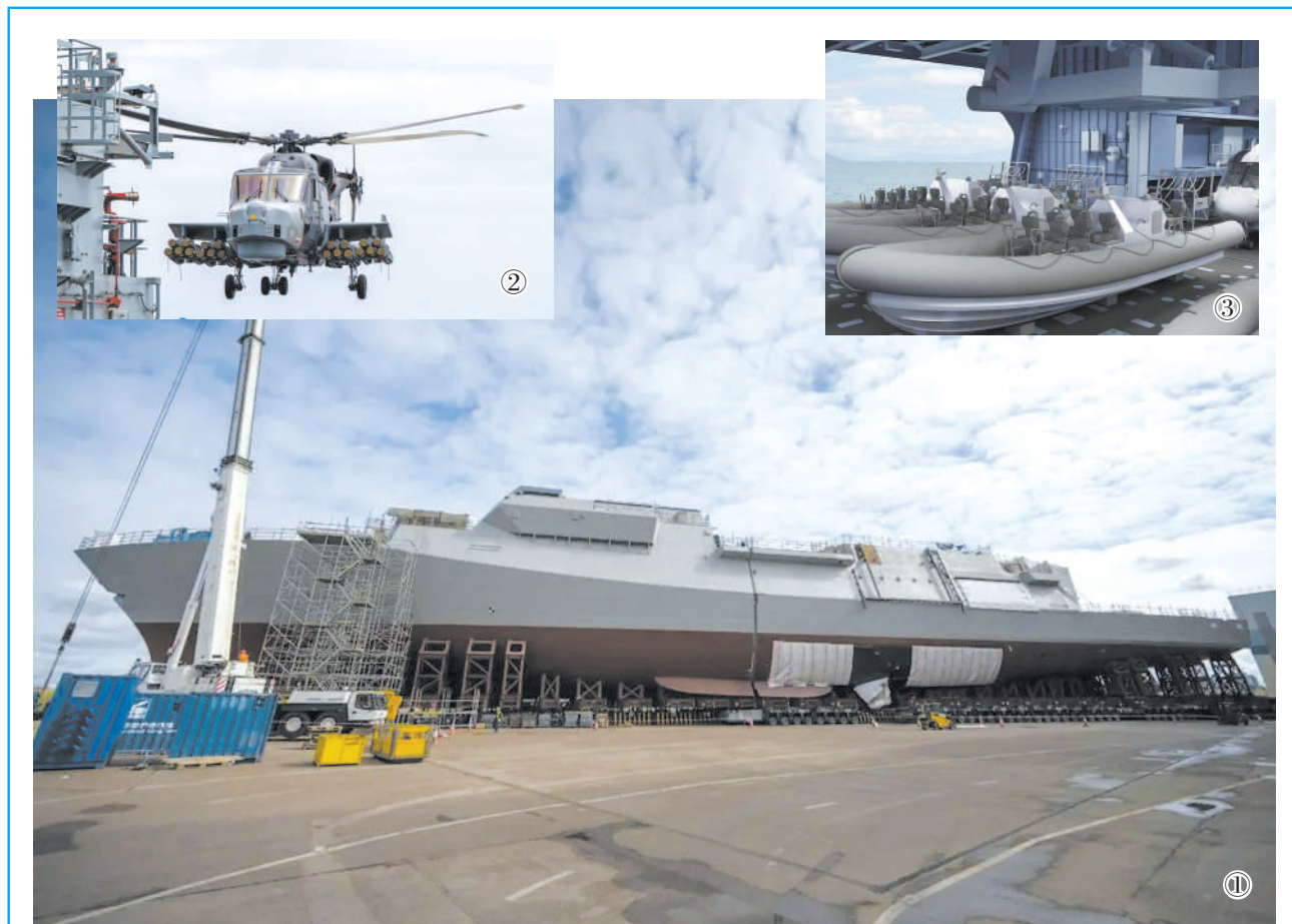
图①:英国海军第一艘26型护卫舰“格拉斯哥”号船体建造完成;图②:一架携带20枚“欧洲燕”导弹的“野猫”直升机从“百眼巨人”补给舰上起飞;图③:26型护卫舰多任务载荷舱概念图。
