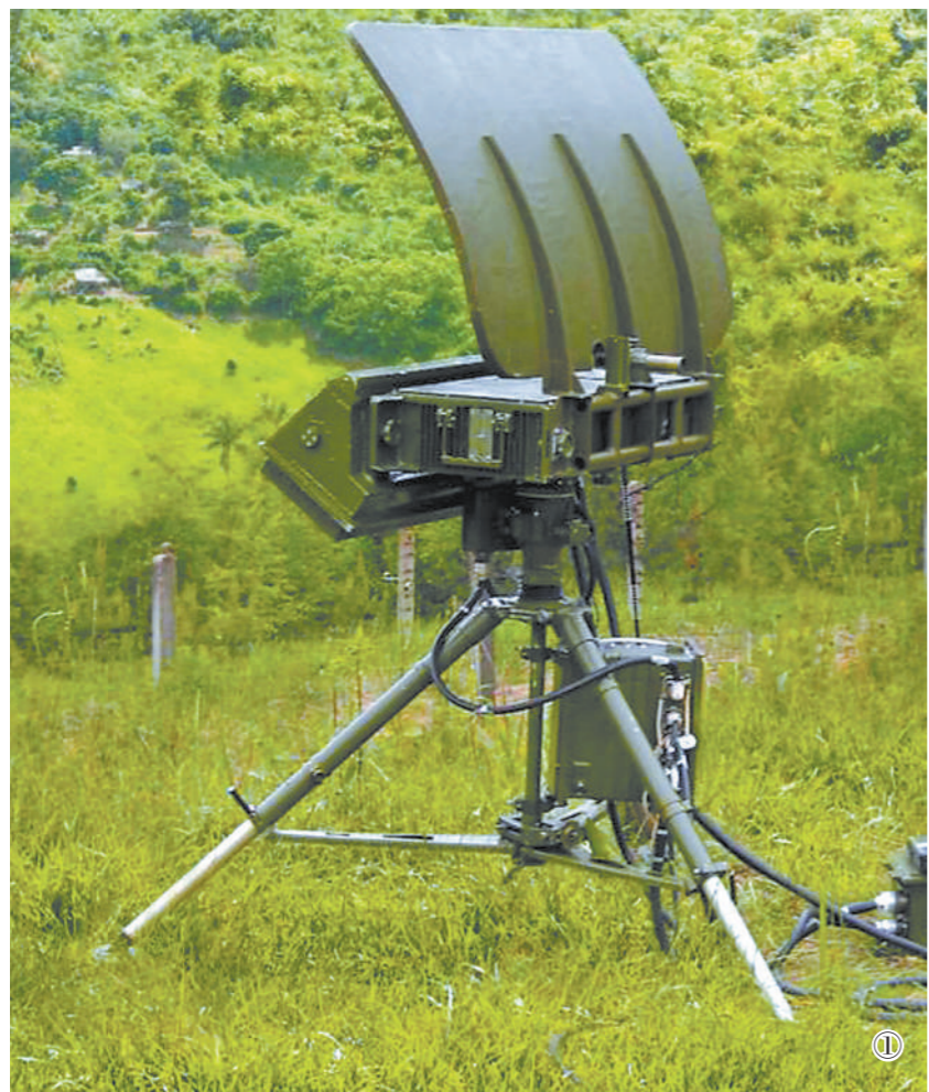
图1:俄罗斯Aistyonok 1L271便携式反炮兵雷达;图2:美国MSTAR便携式雷达;图3:俄罗斯FARA-1便携式雷达;图4:美国AN/PPS-15便携式雷达。
