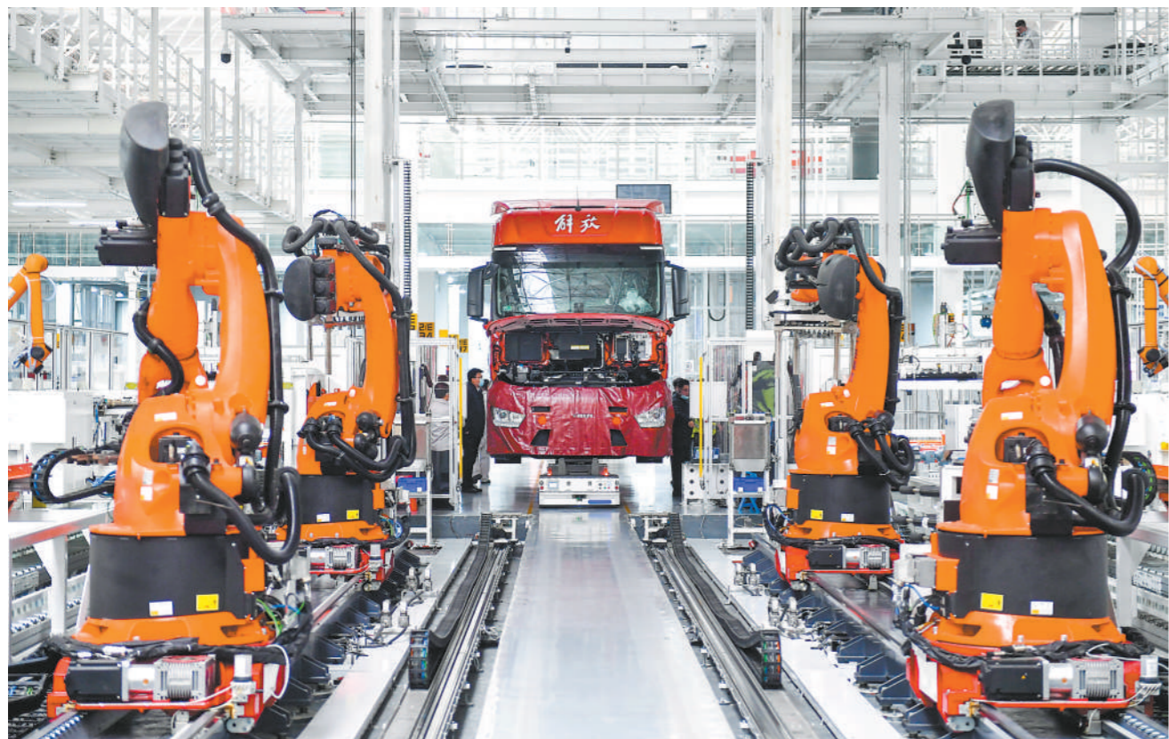
人勤春来早,吉林省各地积极推动企业生产、项目建设,工地车间一派忙碌景象。图为日前员工在位于吉林长春的一汽解放J7智能工厂内进行整车装配作业。
