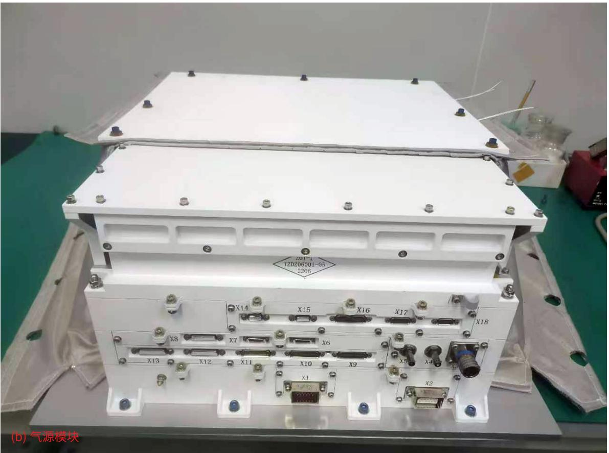
图 4-19 燃料电池载荷装置
