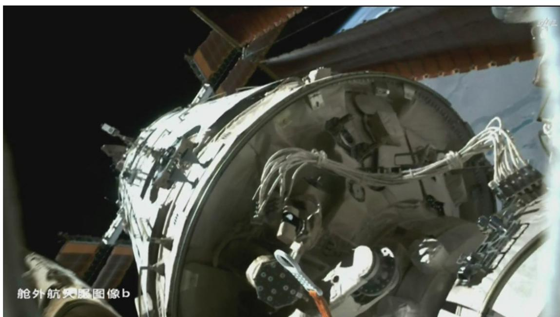
图 4-3 连接舱段的舱外光缆组件
