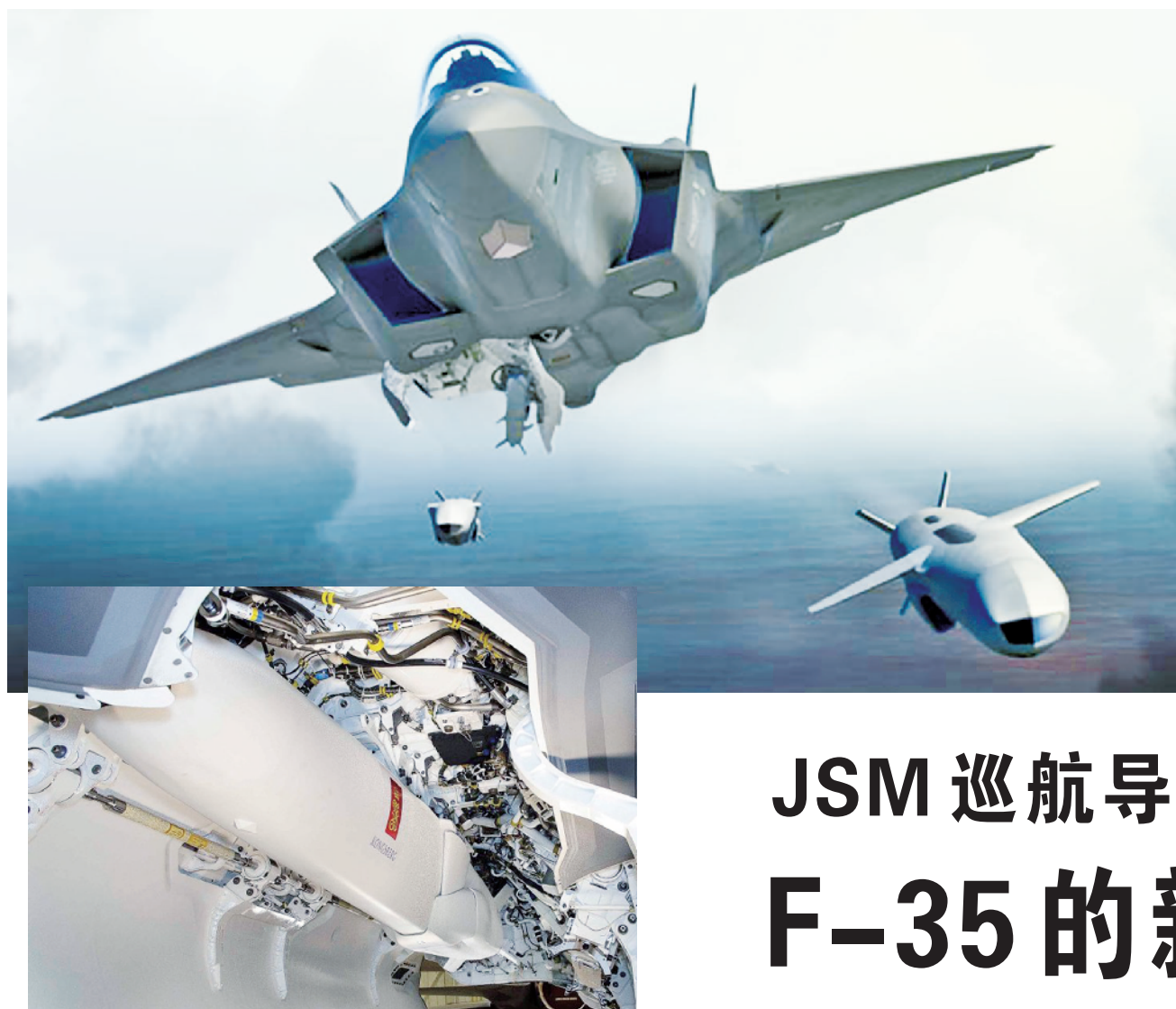
大图为F-35战斗机发射JSM导弹示意图。小图为挂载在F-35战斗机弹仓中的JSM导弹，两侧进气道处于封闭状态。
