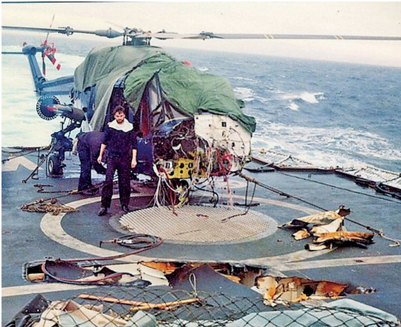
英军“大刀”号护卫舰的直升机起降甲板被阿根廷空军未爆弹砸出大坑
