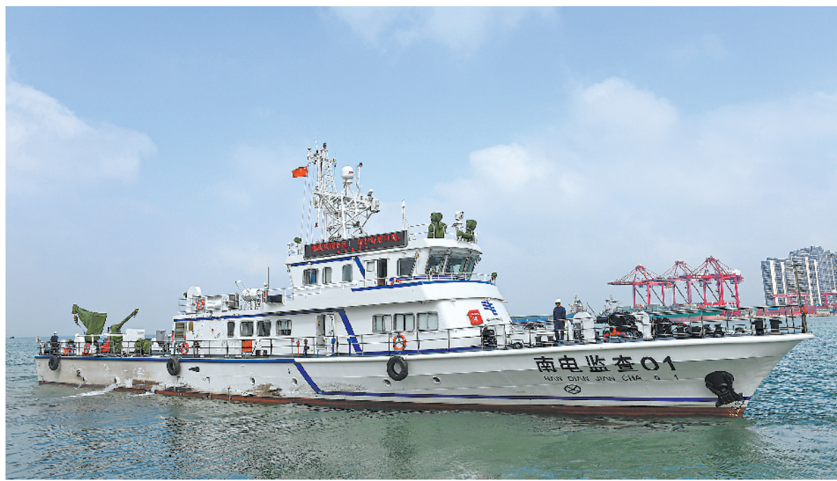
近日,海底电缆综合运维船“南海监查01”在海口交付使用。这是国内首艘具备500千伏海底电缆进行高速巡航和低速定位检测的海缆运维船,填补了国内海缆运维检测方面的技术空白。
