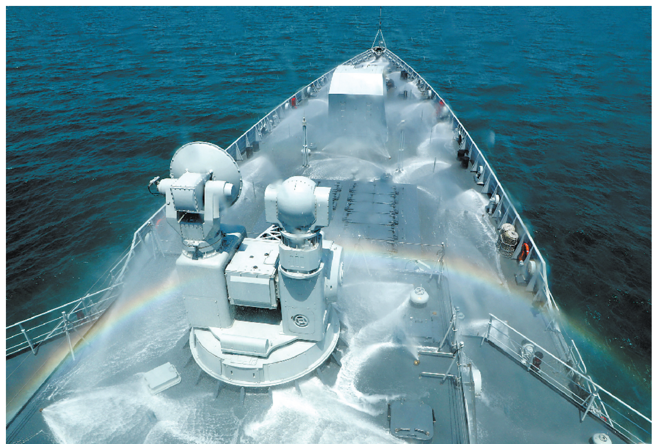
3月底,北部战区海军某舰艇训练中心组织开展实战化训练。图为舰艇开启水幕系统。
